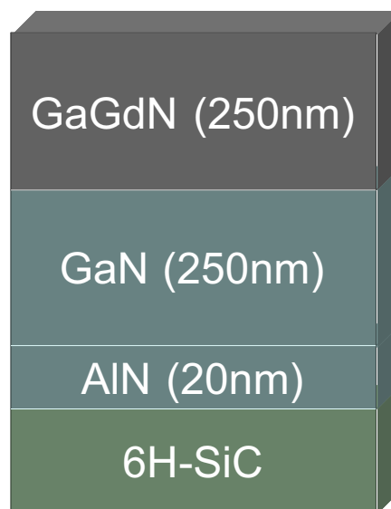
図 1 GaGdN(Gd:6%)のサンプル構造
