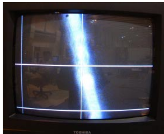
図9 側面カメラによる試料の中心位置調整
