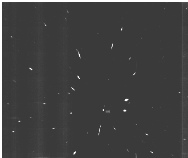
図3. 冷間加工度 0% (応力無負荷) 材の回折パターン
