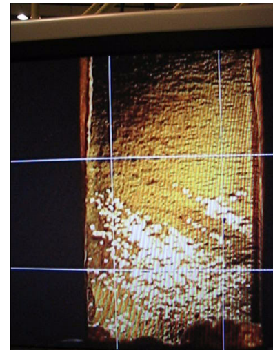
図 5 基板の塑性変形開始後さらに塑性変形を加えた試料の表面状態の c c d 画像。超伝導層の剥離が基板のすべり帯形成方向に沿って進行していることを示唆する結果が得られた。
