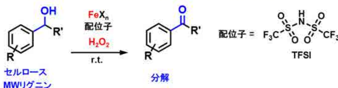
図1. 鉄アミド錯体を触媒として用いる有機分子の酸化変換反応
