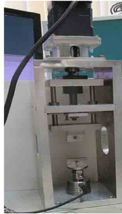
図 2. 本課題で使用したその場引張り荷重負荷装置の概観
