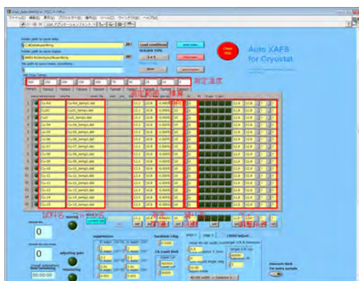
図 1. 低温 XAFS 測定自動化プログラム
