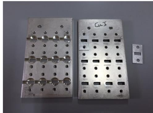
図 1. 5 mm $\phi$ 試料用銀製ホルダー
