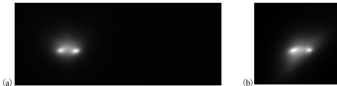
図1. 0.72BiFeO 3 -0.28BaTiO 3 結晶の300回折線(2θ ≈ 70°) (a) 2θ-χ画像(縦方向が2θ、横方向がχ[011]に相当)、(b) 2θ-ω画像(縦方向が2θ、横方向がω[0-11]に相当)。
