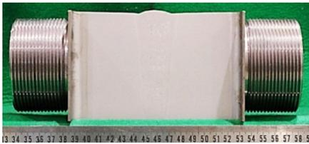
図 1. 平板継手試験片の外観
