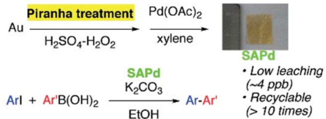
図1. SAPdの製造方法、鈴木-宮浦カップリング反応
