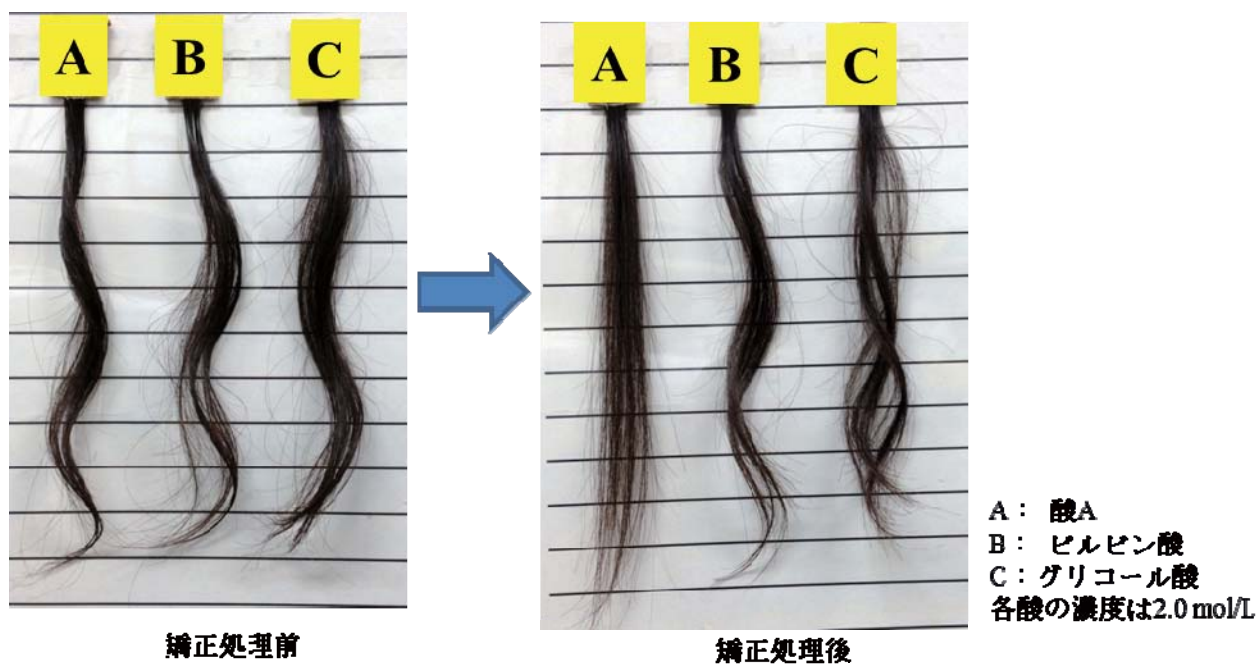
図 2. 毛束での各酸による縮毛矯正効果の比較
