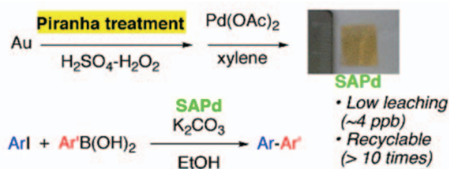
図1. SAPdの製造方法、鈴木-宮浦カップリング反応
