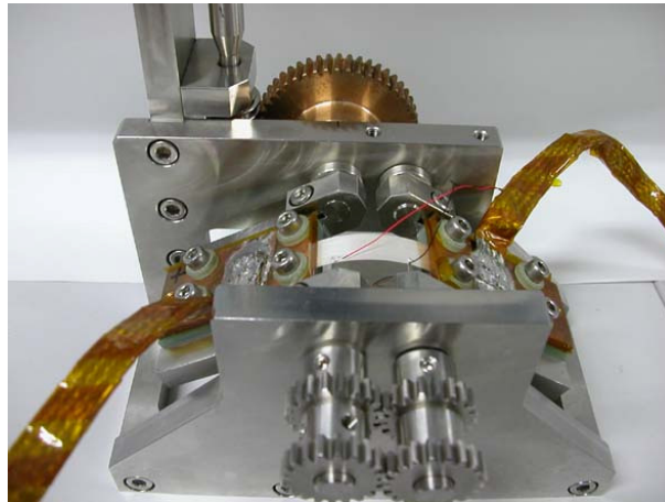
図 1. 臨界電流の曲げひずみ測定を行うための Goldacker 型曲げ装置。ギアの連結によって、試料ステージが左右対称に回転し、超伝導線材を一定曲率で曲げる仕組みになっている。
