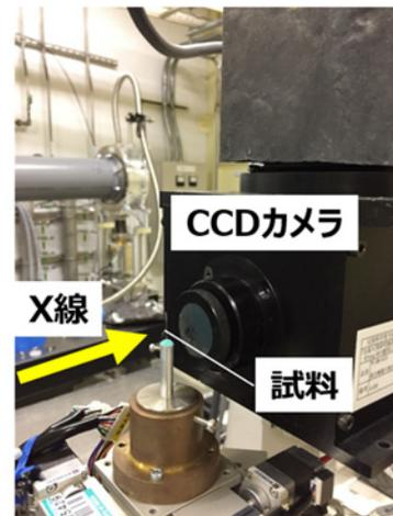
図2 X線CT測定の配置
