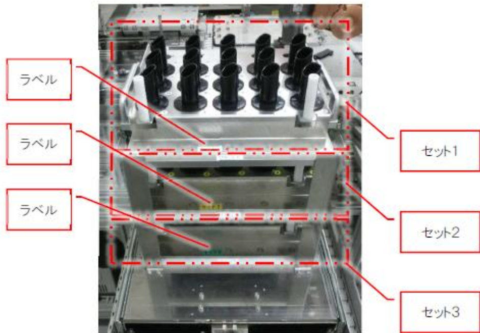
図 15 パレット供給装置
